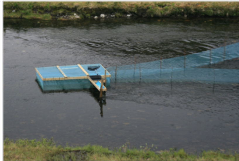
Figur 12 Prinsippsskisse, bilde av kalv i oppsamlingsburet (venstre) og komplett oppvandringsfelle (høyre).
