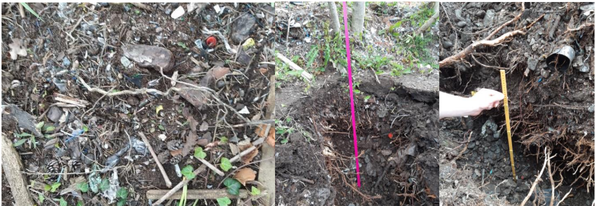
Bilde 5,6,7 viser det øvste lag med jordmonn, samt metode for manuell måling etter graving med maskin. Her finner vi plast ned på 110cm djupna.
