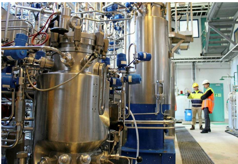
Reaktorer for fermentering hos Borregaard. Foto: Gunn Evy Auestad / NMBU
