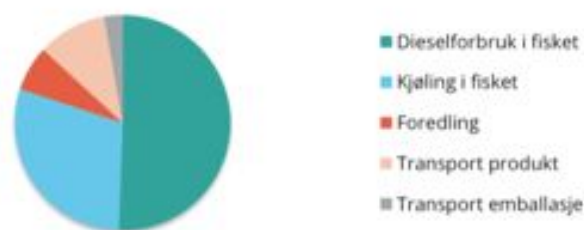
Figur 6.a.1: Utslipp av klimagasser omregnet i CO 2 ekvivalenter for frosset torskfilet levert Paris. Figuren viser andelen av klimagassutslipp for ulike deler av produksjons- og transportkjeden for en torsk fangstet og videreforedlet i Norge før transport til engroslager i Paris. Figuren viser at de største utslippene av klimagasser skjer gjennom dieselforbruk og kjøling i fangstleddet. (Kilde: Sintef fiskeri og havbruk 2 )
