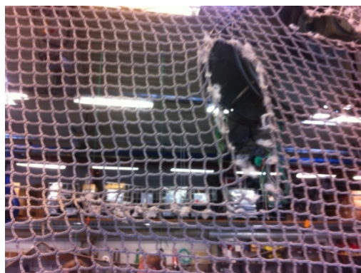
Figur 7: S-krok (representerer not-krok) og resulterende skade i notlin.
