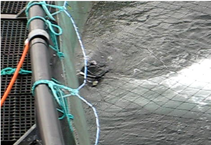
Figur 6: Strøm og bølger kan dytte vaskeutstyret vekk fra nota.
