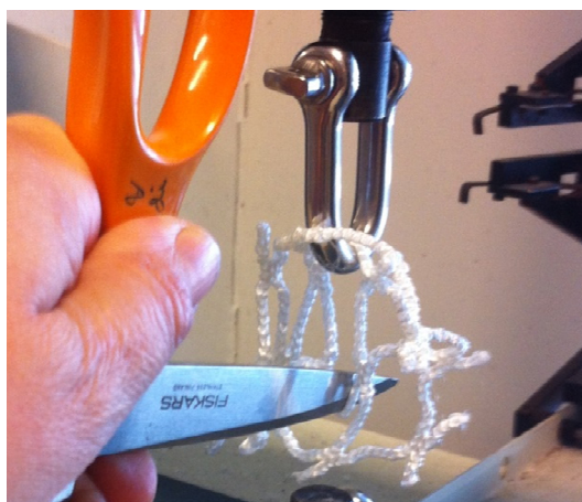
Figur 5: Testing av styrke til notlin belastet gjennom en skarp kant, her representert med et sakseblad.
